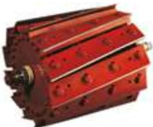
Сердцем кормоуборочного комбайна New Holland является массивный измельчающий барабан с 12-ю ножами. Конструкция измельчающего барабана обеспечивает высокую производительности и качество резки при работе с различными типами культур. Ножи имеют спиральную форму, специальную закалку и наплавку режущей кромки для длительного ресурса эксплуатации. Привод барабана оснащен защитной муфтой для предотвращения поломки при забивании.
